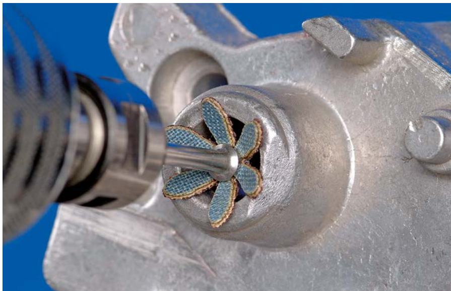
optimálne k odhrotovaniu otvorov a pod.
