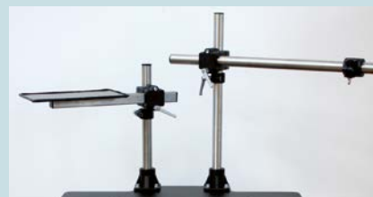
Odkladací priestor vŕavo a rameno na upnutie závesného motora vpravo
