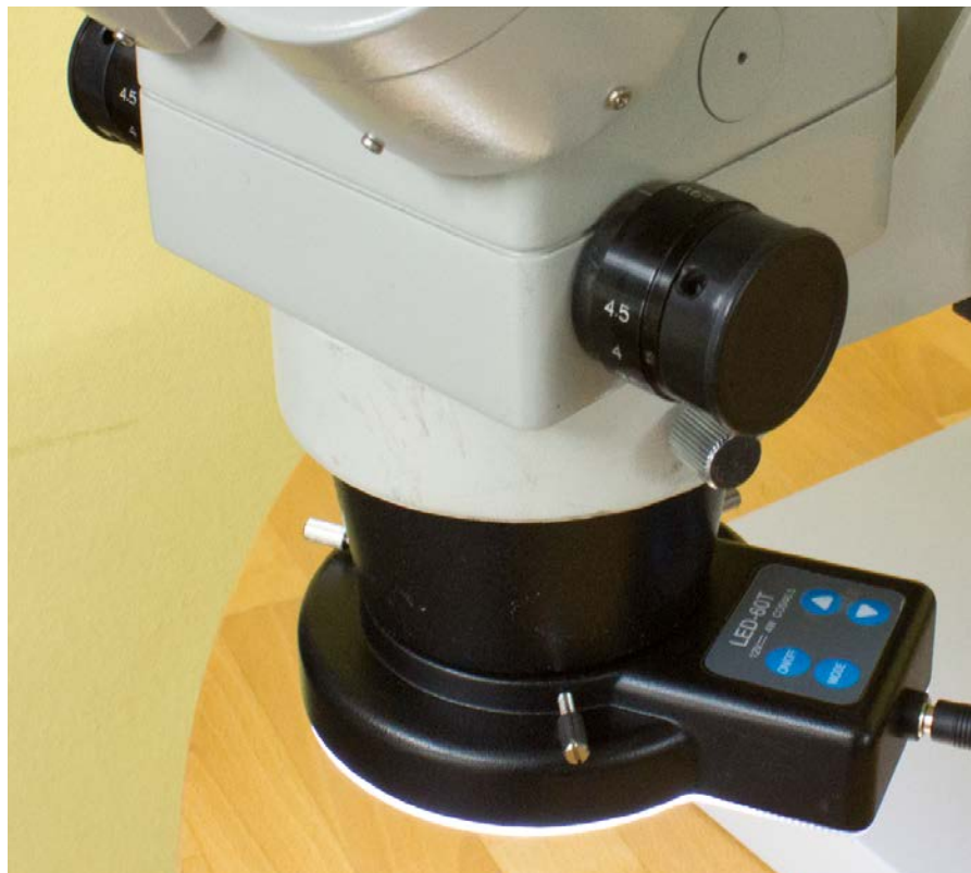
Použitie LED kruhového svetla so segmentovým prepínaním na stereomikroskope SM-200.
