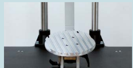
Polohovač joke easy Work s doskou s T-drážkami
